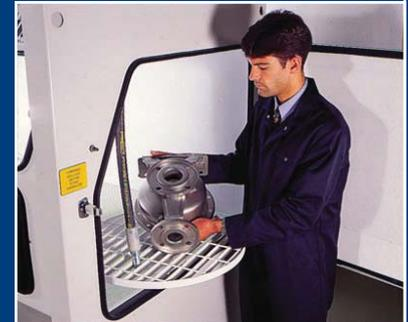
La mesa giratoria opcional facilita la rápida y fácil carga y descarga de componentes
